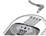
Für die störungsfreie Gruppensuche ist das d3 mit einem Ohrhöreranschluss ausgestattet. Ohrhörerstecker in den Ohrhöreranschluss (2) einführen und das d3 auf Empfang schalten. Im Ohrhörer ist nun das Signal des zu suchenden Senders zu hören, die Suchrichtungspfeile zeigen die Gehrichtung an und im Display erscheint die Entfernung zum Sender. Der Lautsprecher (3) ist im Ohrhörerbetrieb ausgeschaltet.
