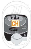
Ein zweites LVS-Gerät wird nun auf Senden gestellt. Nach dem Umschalten des d3 auf Empfangen ist das Signal des Senders zu hören, im Display erscheint die Entfernung zum Sender und die drei Richtungspeile geben die Suchrichtung an. Die Sendekontroll-Leuchte ist im Empfangsmodus ausgeschaltet.
