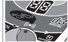
Die wesentliche Hilfe zur Erkennung einer Situation mit mehreren Verschütteten leistet das d3 mit der Signalanzeige durch die rote LED (12). Die rote LED leuchtet, wenn mehrere Teilnehmer im Empfangsbereich verschüttet sind. Geht das Leuchten in ein Blinken über, dann ist der zweite Verschüttete weniger als 10 m entfernt. Die rote LED wird ca. 5 Sekunden nach dem Umschalten auf Empfangen aktiviert. Wenn sich mehrere Signale überlagern, kann dieser Vorgang durchaus bis zu
