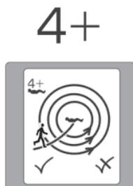
Après confirmation, la sensibilité du récepteur du S1 est limitée à 5 m. Les bandes de recherche sont alors limitées à une largeur de 5 m. Cette limitation des bandes de recherche à 5 m est indiquée par des barres latérales noires à l'écran.
